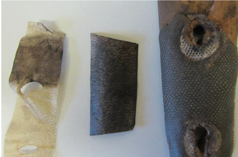
5. kép: A cápbőr pótlás készítési próbái, festett pergamen, a hiányos markolat
